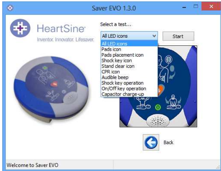
Janela PAD Diagnostic tests (Testes de Diagnóstico do Desfibrilador) do Saver EVO
